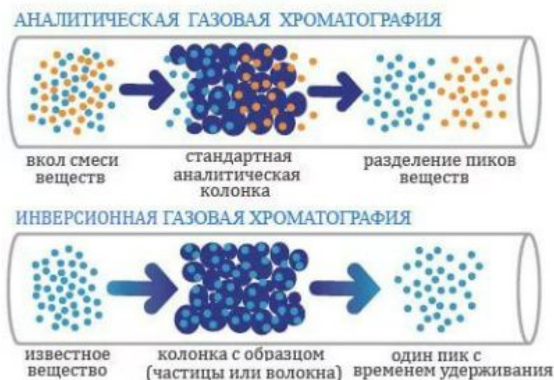
1-сурет. Хроматография әдісінің түрлері
